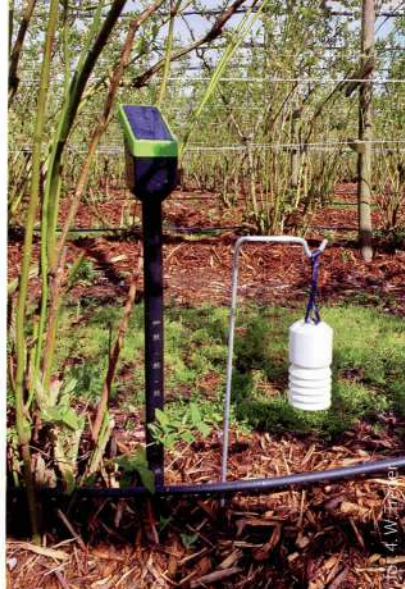
Fot. 4. Sonda glebowa systemu AGREUS
