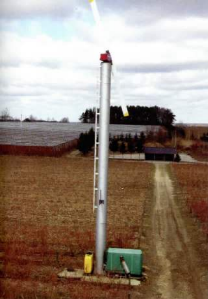
Fot. 3. Wiatraki Orchard-Rite są wykorzystywane do ochrony przeciwmrozowej od 20 lat
